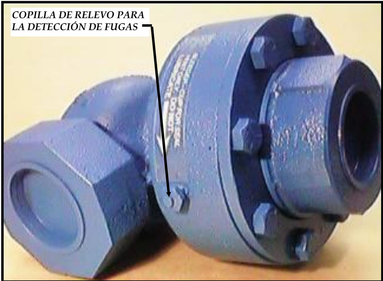
Las Uniones Giratorias, tipo "SMAC", Marca "Full-Circle", son provistas de una copilla de relevo. Las fugas de gas en los sellos mecánicos, pasan por la salida de esta copilla. La manera más efectiva para visualizar cualquier falla de hermeticidad, sería la inspección ocular después de aplicarle un poquito de espuma de jabón: cualquier filtración de producto bajo esta prueba, resultaría burbujas muy fáciles de detectar. Entonces, recomendamos que se haga esta revisión periódicamente.
